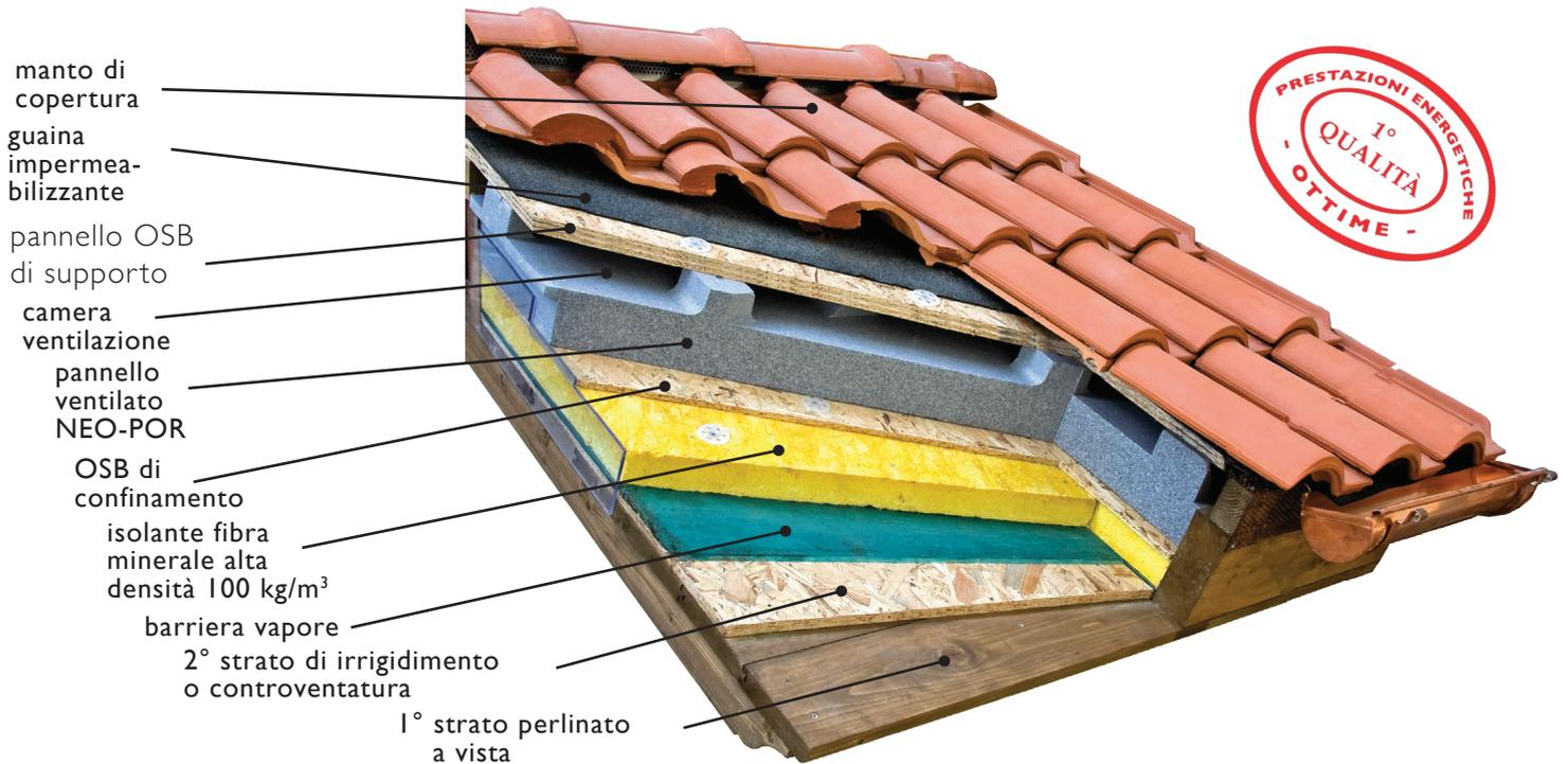
Per ottenere concreti risultati occorre una progettazione valida e integrata, bisogna cioè creare una stratigrafia costituita da elementi portanti alternati a strati isolanti termici ed acustici dove risulta importante oltre la scelta dei materiali anche la loro posizione che possa garantire una adeguata:
