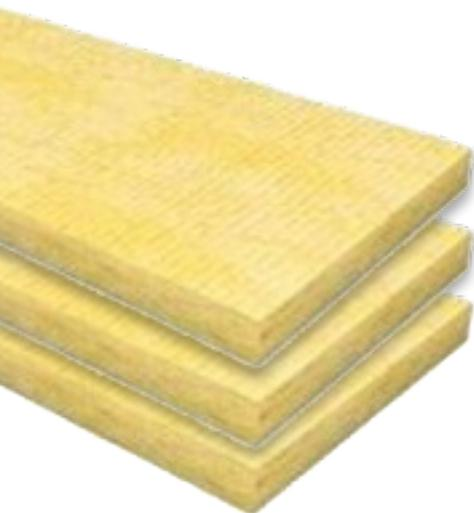
La fibra di vetro è un materiale isolante di origine minerale impermeabile e non attaccabile da parassiti. Ha elevata capacità di isolante termico, e di assorbimento acustico. Fornisce un' elevata protezione dal fuoco, poiché è incombustibile in quanto fibra minerale. E' dimensionalmente stabile al variare della temperatura. Si ottiene utilizzando l'80% di vetro riciclato.
