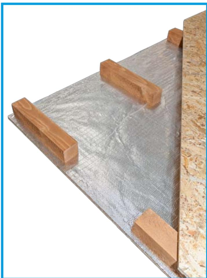
Il **COMPORTAMENTO ESTIVO** del pannello **Eclettico Reflex** è di tipo **ALTO RIFLETTENTE**, essendo munito di una parete **ALTO RIFLETTENTE** con coefficiente di assorbimento solare pari a 0,09. Questo significa che in estate esso riflette il 90% del calore assorbito verso la camera di ventilazione e da questa smaltito.
